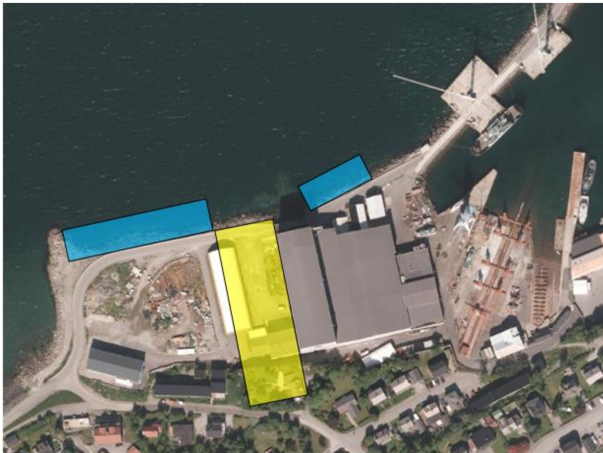
Figur 2. Flyfoto over verftsområdet til Slipen Mekaniske. Planlagt område for ny tørrdokk er markert med gult og de aktuelle utfyllingsområdene i sjø er markert med blått (kilde: http://www.kart.finn.no ).
